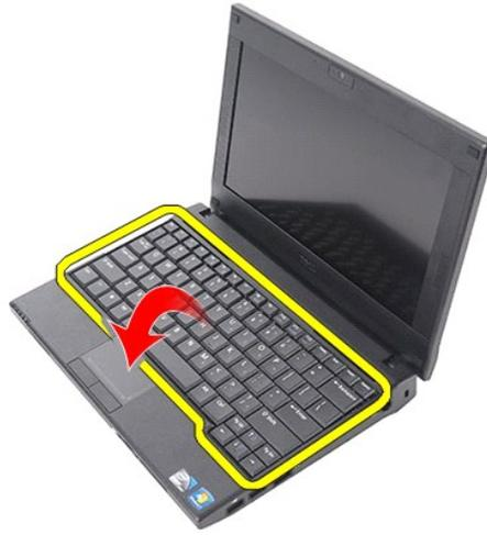
6. انفصل كبل بيانات لوحة المفاتيح وقم بإزالة لوحة المفاتيح من الكمبيوتر.
