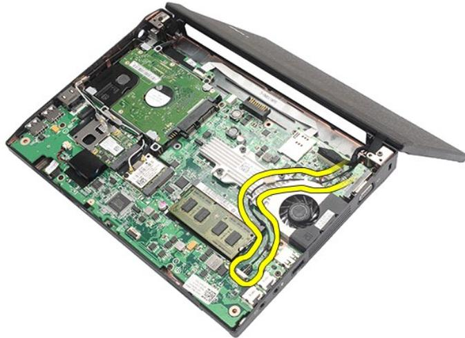
6. انفصل كبلات الهوائي من بطاقة WLAN، ثم قم بإزالة الكبلات من مسار التوجيه الخاص بها.
